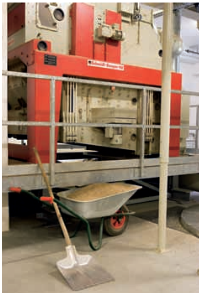
Vorbereitung: Das Getreide wird in riesigen Filtern und Mühlen gesiebt, gereinigt und gemahlen
